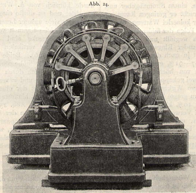
Drehstrom-Gleichstrom-Transformator für eine Leistung von 100 000 Watt.
