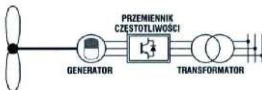
Rys. 2.7c Układ z generatorem synchronicznym z magnesami trwałymi
