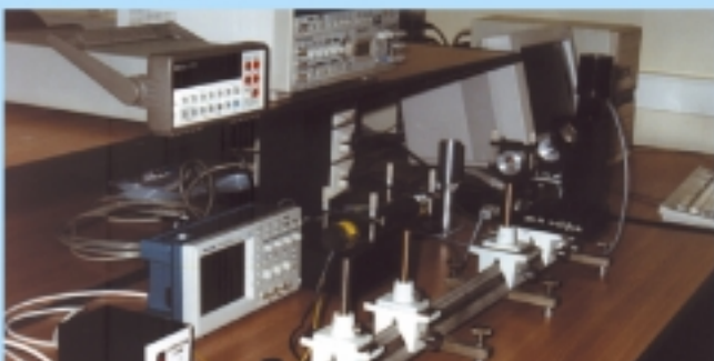
Laboratorium fizycznych podstaw pomiaru – stanowisko do badania diod kwadrantowych
