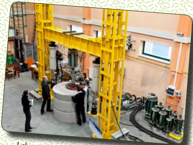
Laboratorium Wydziału Budownictwa (PO), gdzie można badać konstrukcje betonowe m. in. symulując trzęsienie ziemi.
