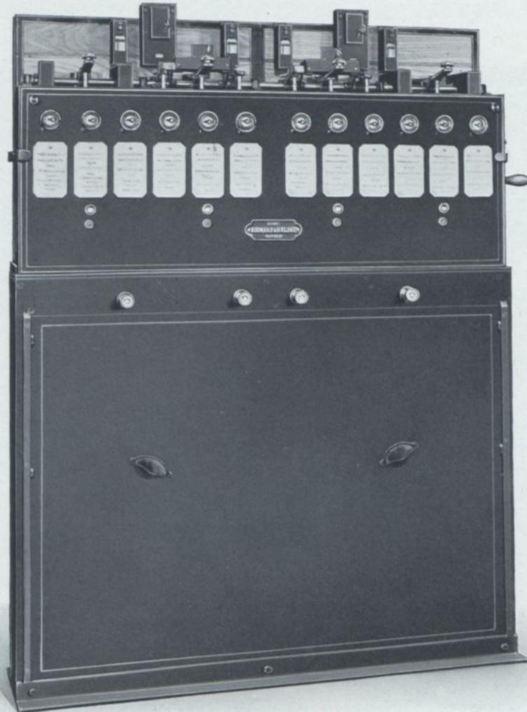
Abb. 93. Signalschalterwerk mit Blockwert für halbselfsttätige Streckenblockung.
