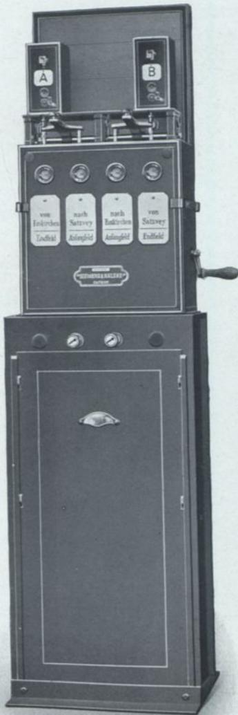
Abb. 92. Schalter- und Blockwerk einer Blockstelle.
