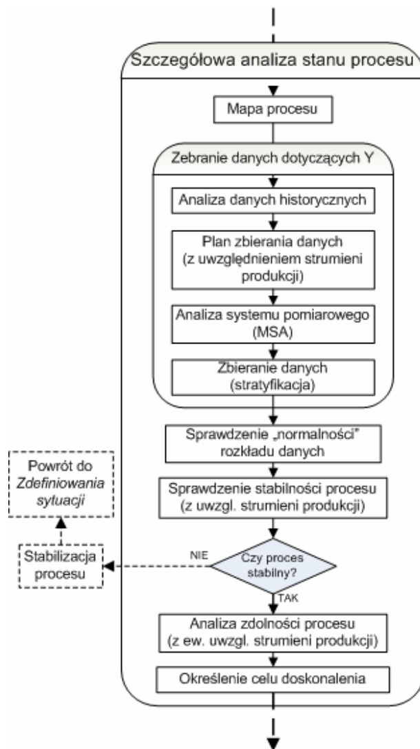
Rys.4.3. Drugi etap Metodyki redukcji zmienności procesów obróbki skrawaniem – Szczegółowa analiza stanu procesu
