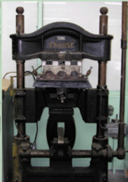
Stara maszyna „Krause” jest wciąż piękna. Służy do tłoczenia na sucho i złączenia.
