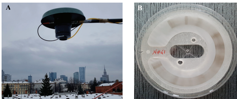
Rys. 1. Pobornik Streaker – PIXE International Corporation (A) oraz filtr z materiału Nuclepore z pyłem PM_{2,5} zebrany w ciągu 1 tygodnia (B). Fot.: M. Reizer
