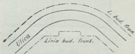
Rys. 57. Linia budowlana cofnięta po stronie wypukłej ulicy.
