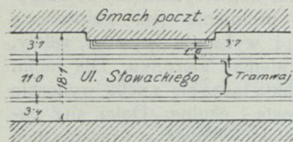
Rys. 112. Wejście do gmachu głównej poczty we Lwowie. Przez niefortunny rezalit i schodki, przedzielone przytem kandelabrami na pola, zwężono chodnik w ruchliwej ulicy do 1'60 m.
