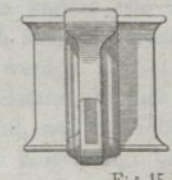
Fig. 15. Vorderansicht des 3 ten Lagers von Gusseisen.
