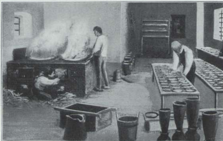
Abb. 3. Eindampfen des geklärten Rübensaftes und Kristallisation des Zuckersirups.
