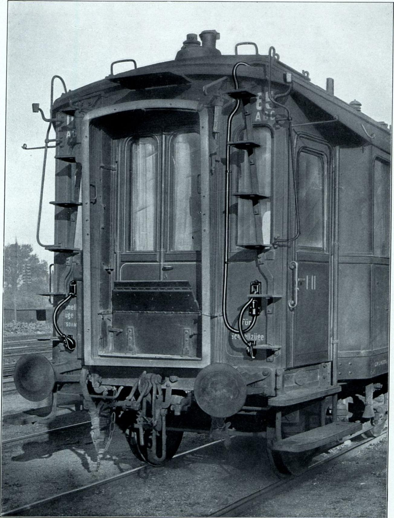
Ansicht der Stirnwand eines D-Zugwagens mit elektrischer Leitung und Kupplungsschaltern.
