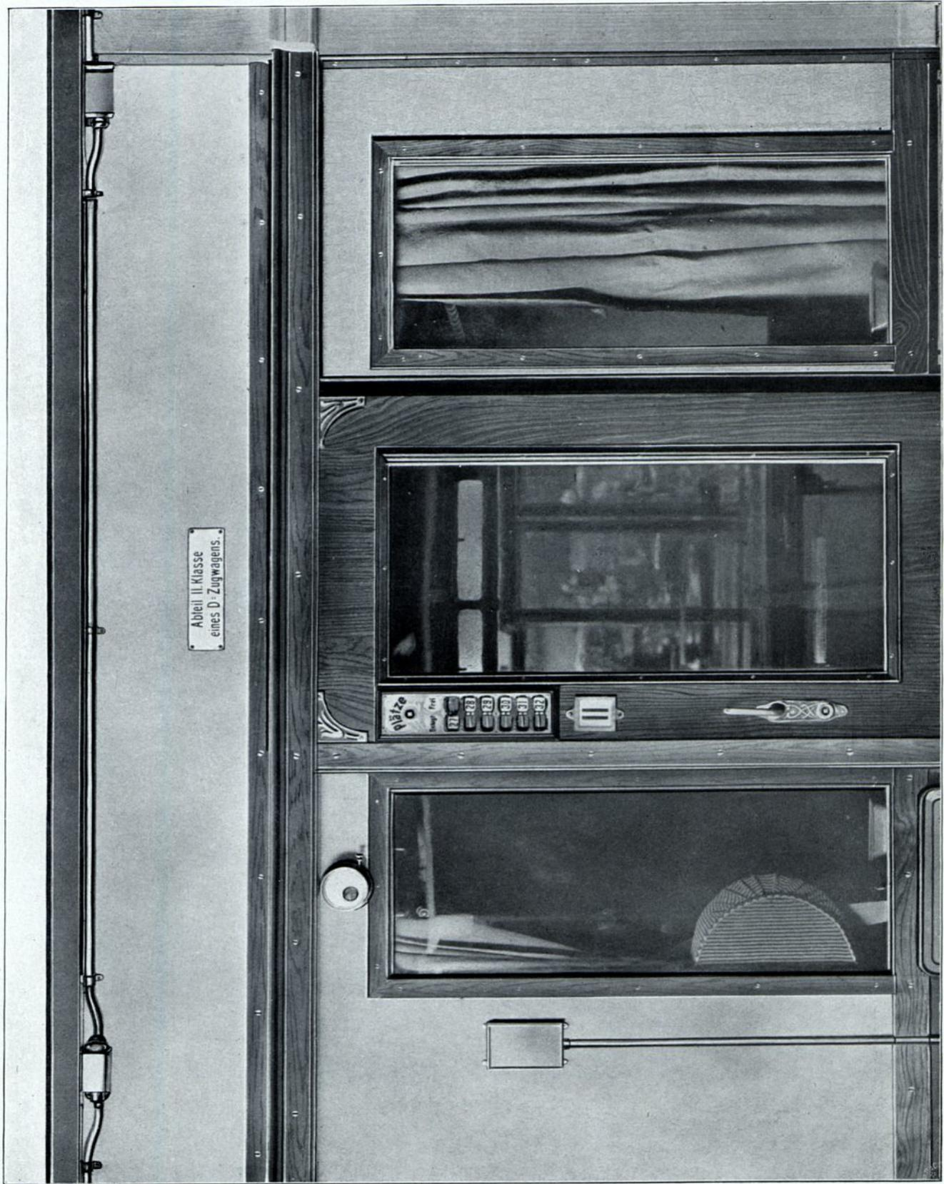
Leitungsverlegung im Seitengang eines D-Zugwagens mit Abzweigstellen zu den Abteilen.
