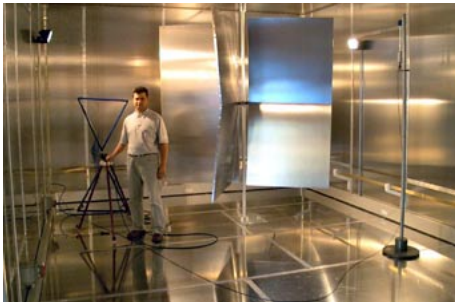
Dr inż. Zbigniew Jóskiewicz podczas kalibracji stanowiska do pomiarów odporności na pole elektromagnetyczne w komorze rewerberacyjnej.
