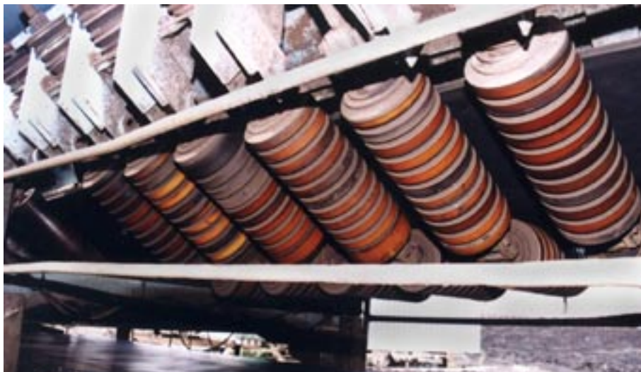
Pierścienie poliuretanowe krążników dolnych przenośników taśmowych
