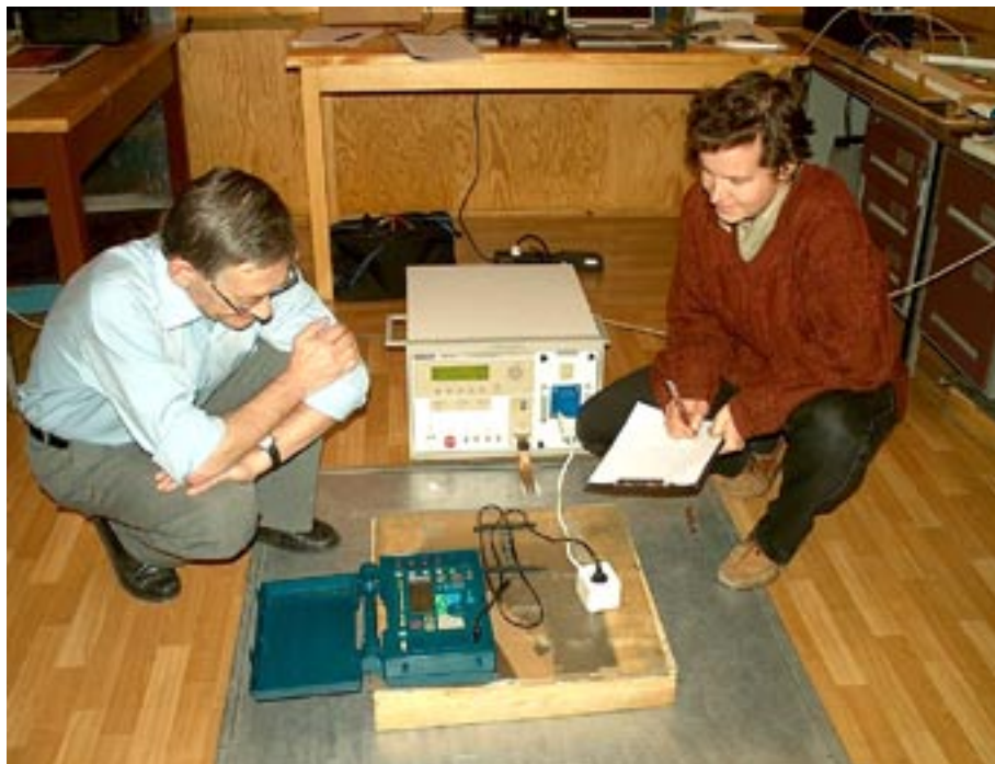
Test odporności na serię szybkich stanów przejściowych typu „burst” – obserwacja reakcji obiektu (dr inż. Ryszard Wroczyński – LKE oraz mgr inż. Aleksandra Nowaczyk – SONEL S.A.).
