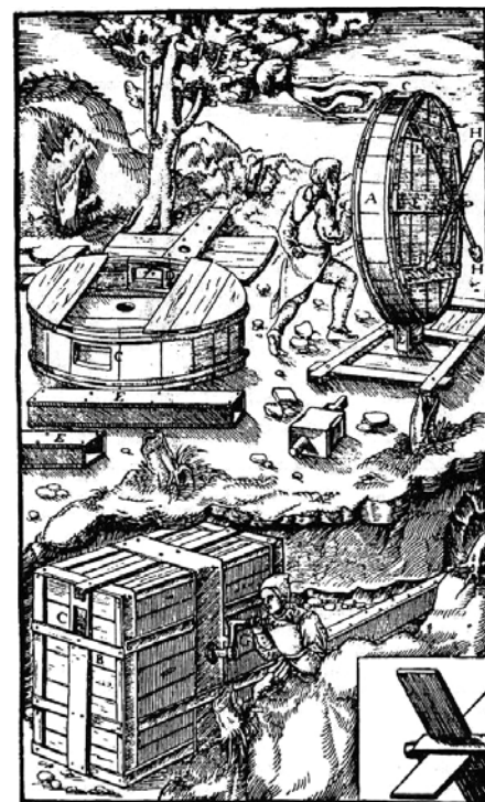
Beben A. Skrzynia B. Wylot powietrza C. Inny otwór D. Długi przewód wentylacyjny E. Wół F. Korba wału G. Drągi H-I.
