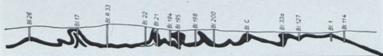
Abb. 48. Durch Eisschub gefaltetes Braunkohlenflöz (Grube Merkur bei Drebkau, N.-L.). Beachtenswert die verschiedenen Ergebnisse der einzelnen Bohrungen! Umgezeichnet nach PRETZSCH und RUSSWURM.
