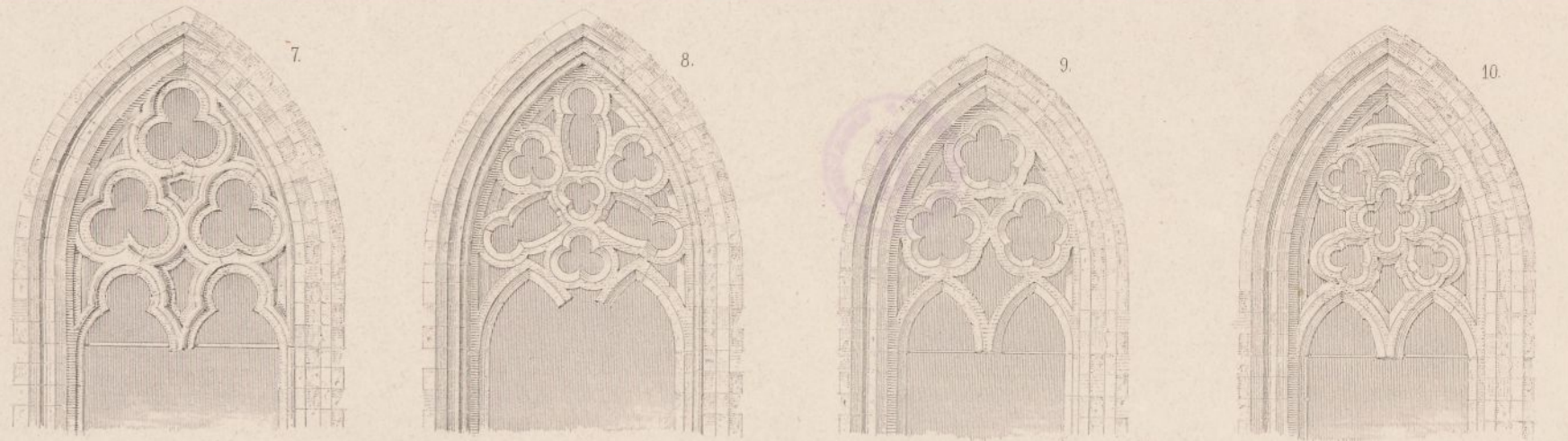
Fenster im Chor (andere Stab- + Maßwerks Profil als im Schiff)
