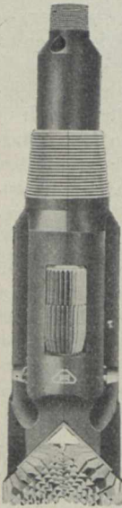
Abb. 19. Fräsender Steinbohrer. (Rock one bit von Hughes Tool Comp., Houston/Texas.)
