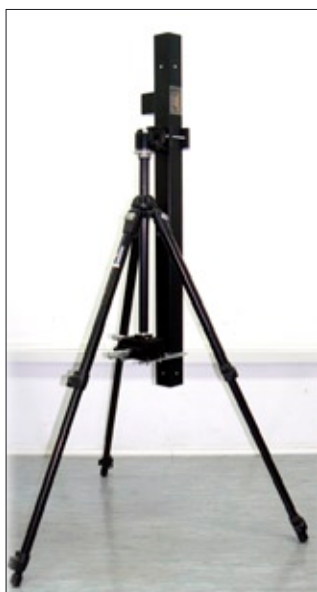
Prototyp pionownika laserowego autorstwa M. Sidorowicza
