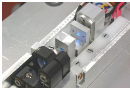
Laser, wykonany przez M. Matysiaka, i obraz profilu wiązki lasera Nd:YAG/BIBO 473 nm
