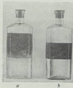
ABB. 4. Prüfung von Maschinenöl auf Emulgierbarkeit a. mit destilliertem Wasser; b. mit 4% Kochsalzlösung
