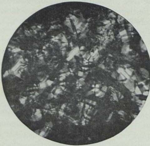
Bild 4. Bleilinoleat in lamellarer Bildungsform. Sehr dünne Gebilde, die Interferenzstreifen zeigen. Entsteht bei gewissen Sorten Bleiweiss
