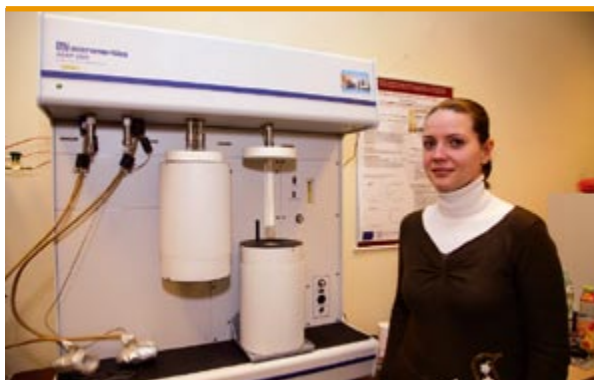
Justyna Krzak-Roś obsługująca system do pomiaru porowatości Micromeritics
