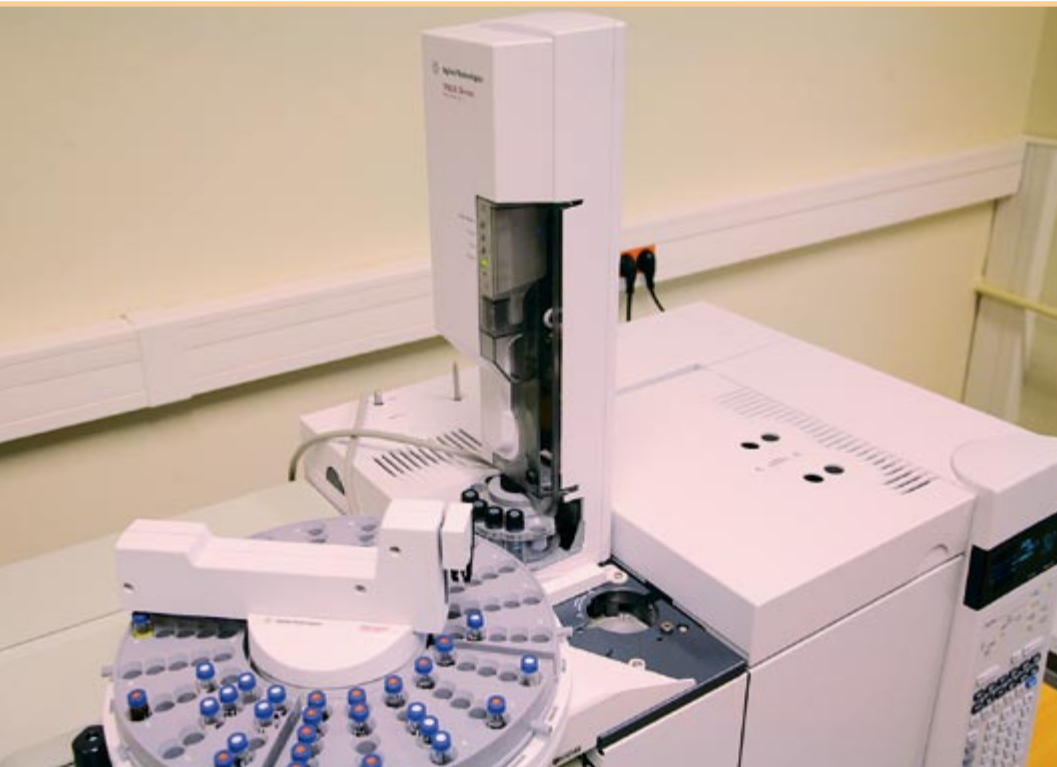
Automatyczny podajnik systemu CGT Premier mieści 100 próbek
