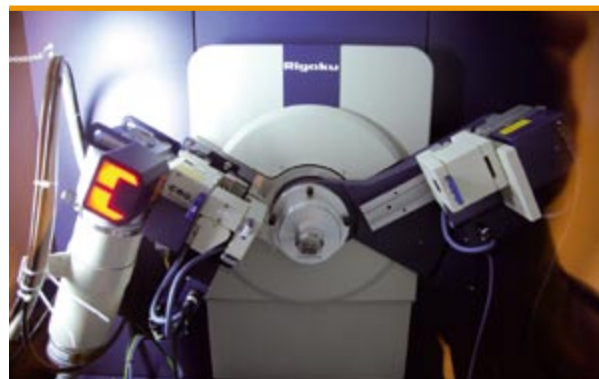
Proszkowy dyfraktometr rentgenowski ULTIMA IV firmy Rigaku
