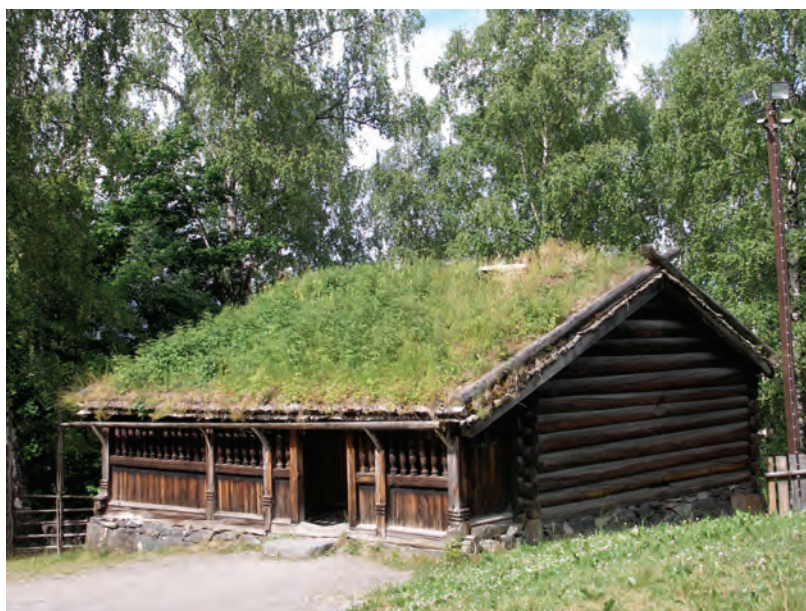
Il. 4. Drewniany dom mieszkalny z przełomu XVII i XVIII w. kryty darnią, bezokienny, wybudowany w konstrukcji laga – reprezentuje pierwotną rzeźbiarstwo norweskiej architektury; skansen Maihaugen k. Lillehammer (fot. E.C.)
