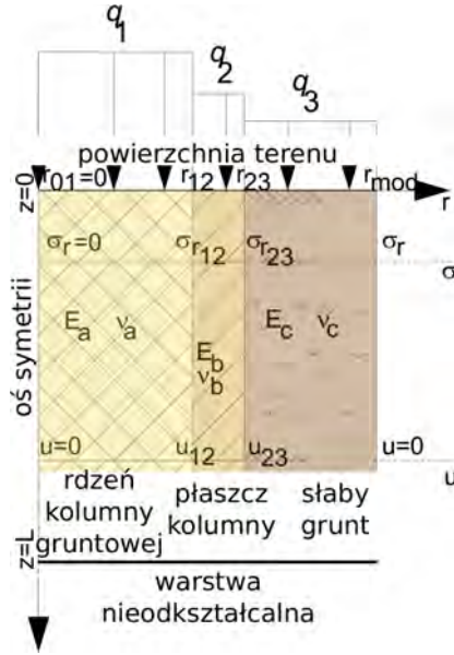
Rys. 3.10. Przekrój przez sekcje kolumny gruntowej wzdłuż osi symetrii z oznaczeniami, wymuszenie obciążeniem podatnym (napężenie na powierzchni kontaktu)
