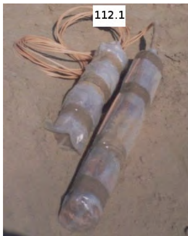
Rys. 3.25. Ładunki z zestawu nr 112.1 przygotowane do umieszczenia w otworze wiertniczym
