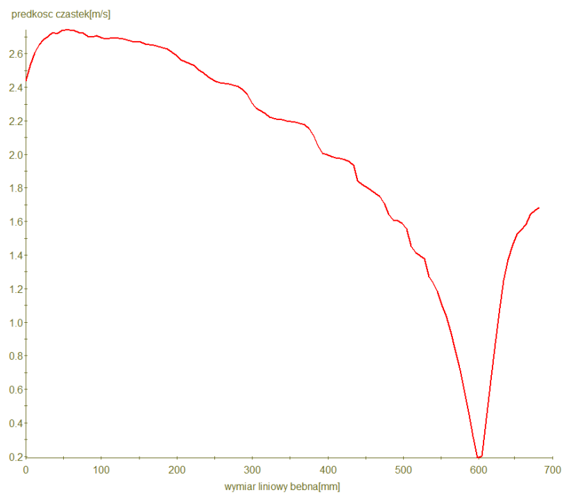
Rys. 89. Prędkość cząstek na linii pomiarowej dla prędkości krytycznej w przekroju podanym na rys. 84, n = 48 \text{ obr/min} , materiał C, D = 700 \text{ mm} , \varphi = 25\%
