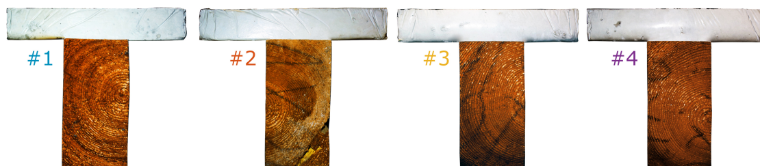
Rys. 4.35. Czola kolejnych belek z widoczną lokalizacją rdzenia pnia drzewa
