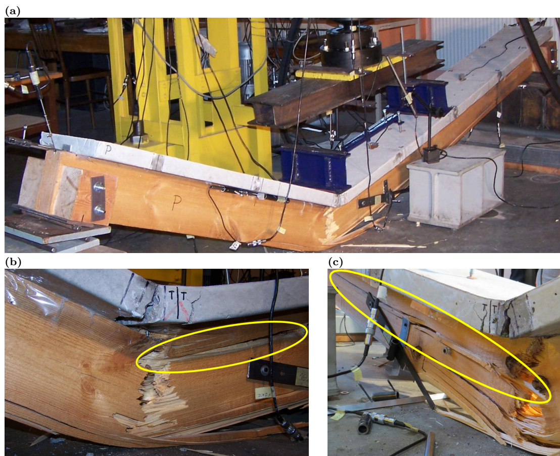
Rys. 4.25. Belka po zniszczeniu (a), miejsca wyczerpania nośności przez ścięcie warstw belki drewnianej zaraz poniżej poziomu ostrza wkrętów (b), (c)
