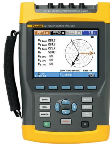
Rys. 2.15. Analizator elektryczny Fluke 438-II [70]
