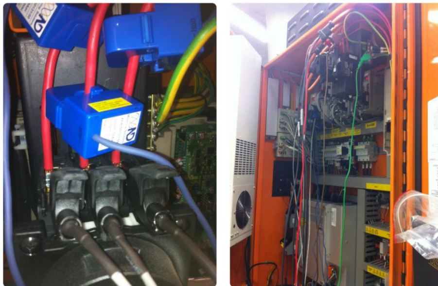
Rys. 2.21. Czujniki prądowe wpięte w szafie sterowniczej przewodów zasilających obrabiarkę [73]
