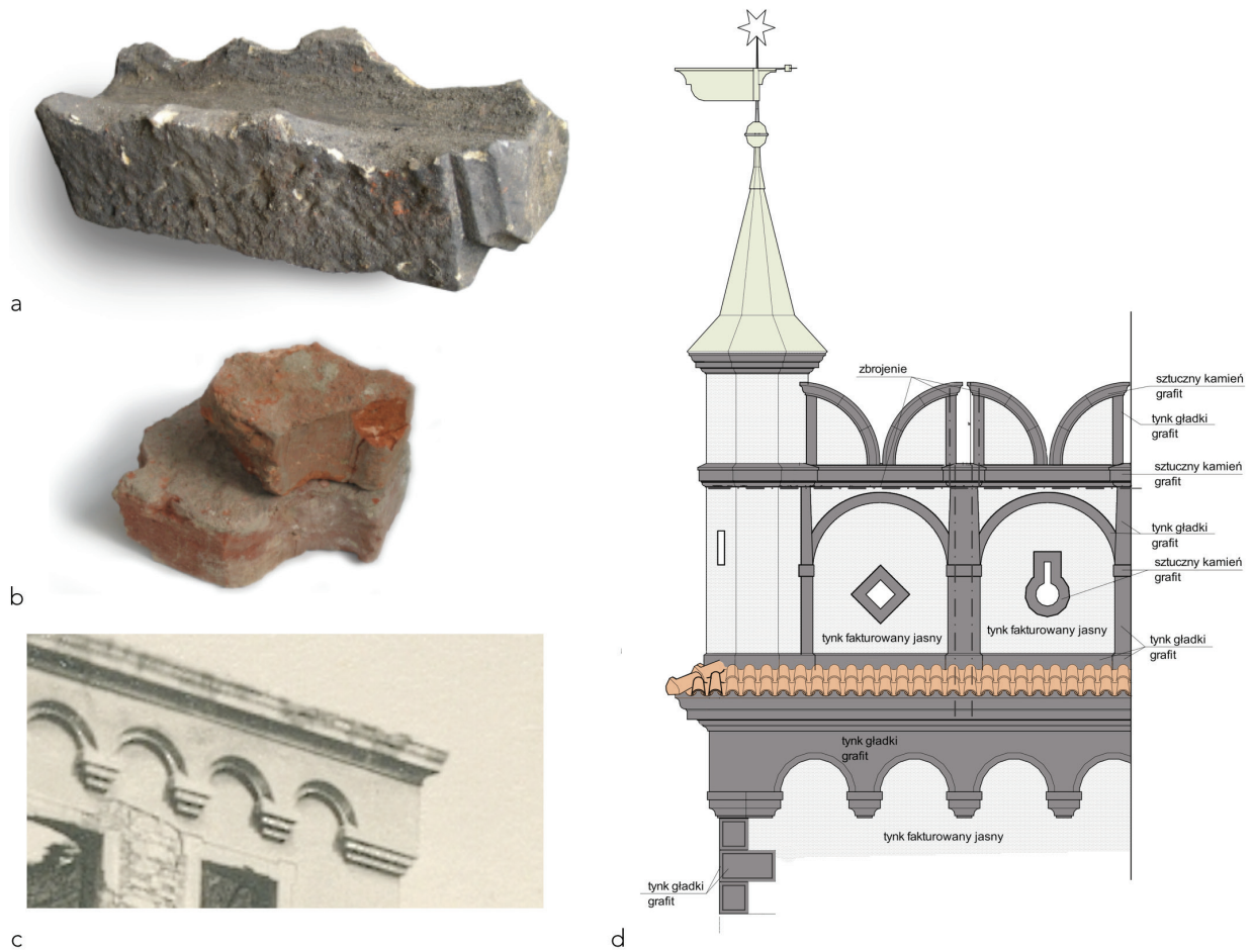
Il. 5. Strzelin, ratusz, ściana attykowa: a) fragment osadzanego na ścianie koryta rzygacza (fot. R. Karnicki [14]), b) wydobyte z zasypów pach sklepiennych profilowane kształtki gzymsowe – okapowe (fot. R. Karnicki [14]), c) fotografia archiwalna, fragment pokazujący artykulację podgzymsowej arkady [17], d) projekt realizacyjny detalu attyki wraz z przyjętą kolorystyką, 2019 r. (proj. R. Karnicki [19])
