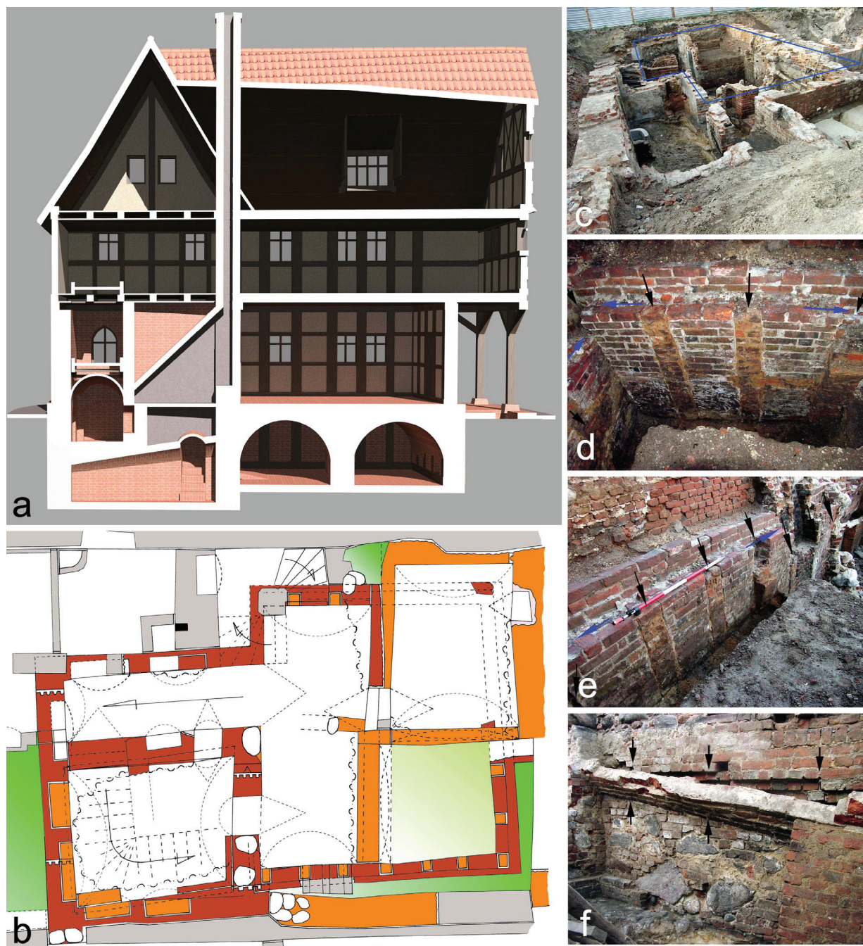
Il. 4. Głogów. Dom ceglano-szkieletowy ze steinwerkiem u zbiegu ulic: Balwierskiej i Garncarskiej (XV w.): a) próba rekonstrukcji; b) rozwarstwienie chronologiczne; c)–f) widok ogólny reliktyw i szczegóły konstrukcyjne pierwotnej budowli (rozebranej w XVIII w.) (pomiar, rozwarstwienie chronologiczne, rekonstrukcja przestrzenno-funkcjonalna i fot.: R. Mruczek i M. Stefanowicz, 2004–2005; wizualizacja i modelowanie 3D: M. Caban, 2016)
