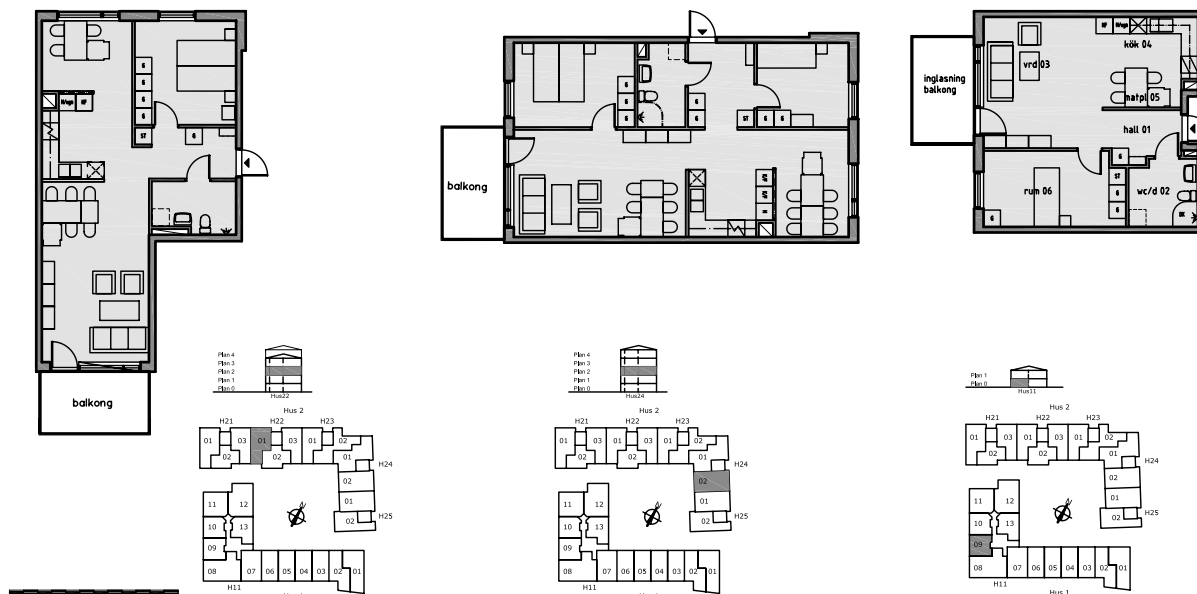
Il. 59. Boo Seniorhem, rzuty różnych typów mieszkań (69,5 m 2 , 82 m 2 , 55,5 m 2 ) oraz ich usytuowanie w strukturze budynku ( http://www.bsk.se/boo-seniorhem-bostader http://www.booseniorhem.se/index_flash.html [dostęp: 17.05.15])
