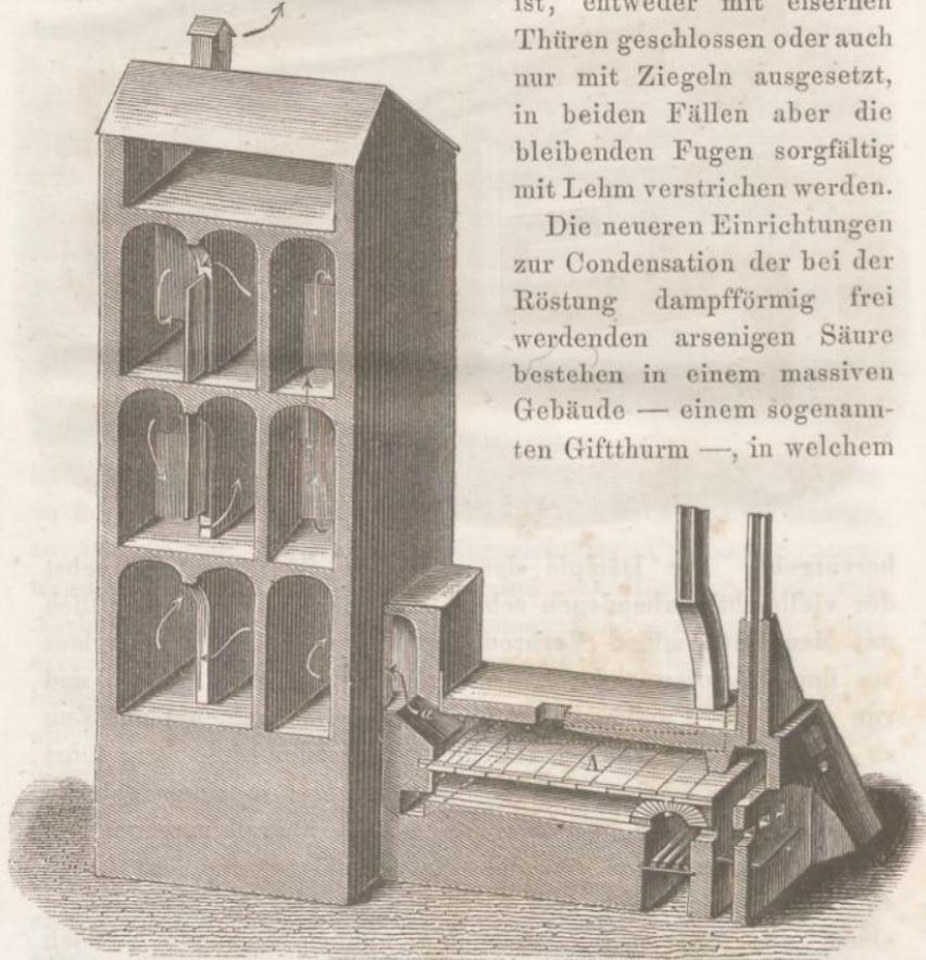
als der Röstofen im Betriebe ist, entweder mit eisernen Thüren geschlossen oder auch nur mit Ziegeln ausgesetzt, in beiden Fällen aber die bleibenden Fugen sorgfältig mit Lehm verstrichen werden.
