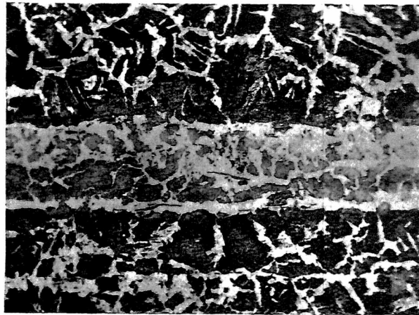
kw. azot. Ryc. 11 a. pow. = 100. Przekrój podłużny wykazuje strukturę materiału. W miejscu zawalcowanej bańki gazowej, wypełnionej znacznymi zanieczyszczeniami.
