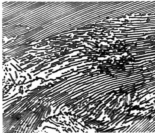
Ryc. 2. Stal o zawartości 0,86% C. Czysty perlit. Kwas azotowy. \times 2000 .
