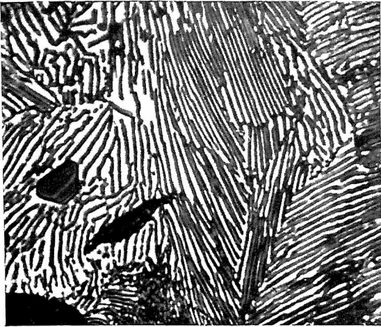
Ryc. 1. Żeliwo perlityczne o zaw. 3,5% C, 1,4% Si, 0,7% Ni. Perlit i grafit (czarne pasemko). Kwas azotowy. \times 2000 .
