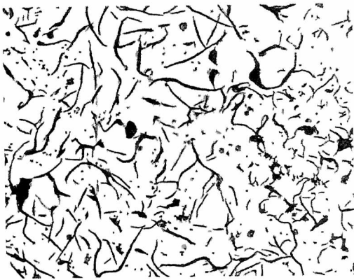
Ryc. 3. Żeliwo. Grafit płatkowy. Nietrawione. \times 75 .
