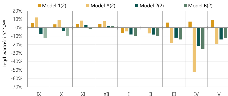
Rysunek 11. Porównanie błędów w miesięcznej wartości SCOP^m pomiędzy modelowaniem przy rzeczywistym i teoretycznym profilu obciążenia cieplnego
