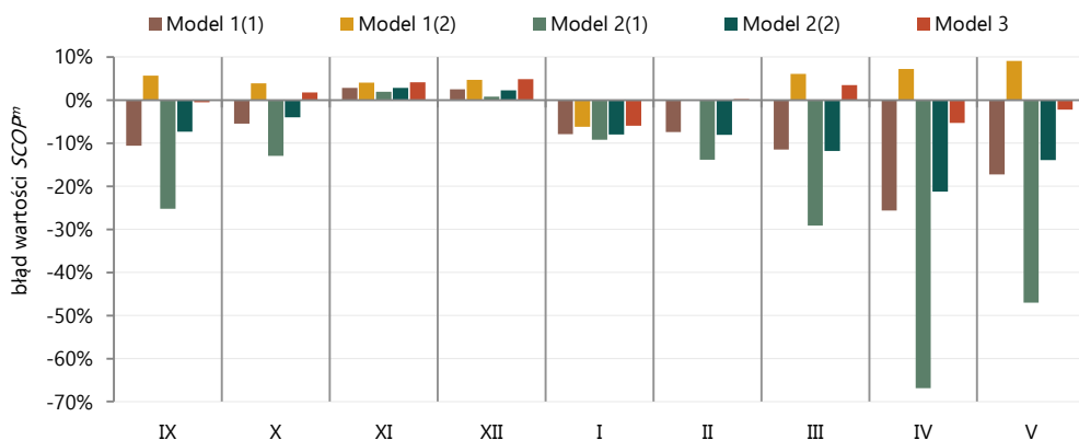
Rysunek 8. Błędy miesięcznych wartości SCOP^m (wyniki symulacji wobec danych pomiarowych)
