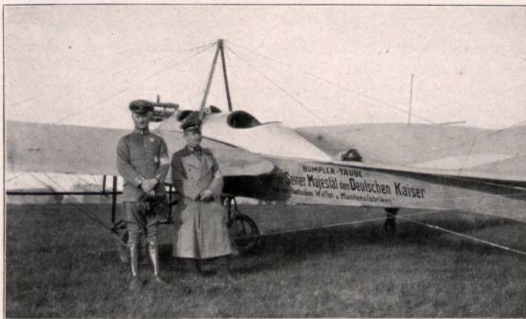
Abbildung 8. Rumplertaube 1913, 100 P.S. Mercedes.
