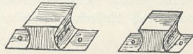
Abb. 35. Apparat gegen das Ausreißen der Rücken beim Beschneiden der Bücher von W. Leos Nachfolger, Stuttgart.
