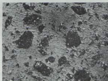
Abb. 4. Berge. Schiefer (kein Relief) und Eisenkies. < 88 \mu . Reliefschliff. v = 100 .
