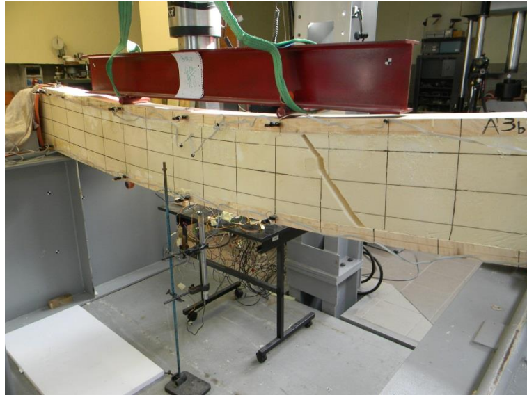
Rysunek 3.5.8 Zniszczenie i jednocześnie wyczerpanie nośności belki trójwarstwowej na skutek ukośnego ścięcia rdzenia poliuretanowego przy jednoczesnym ścięciu pianki przy klejonym połączeniu z pasem drewnianym
