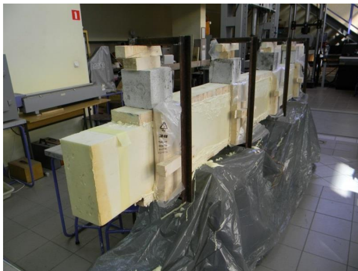
Fotografia 3.2.1 Belka trójwarstwowa w trakcie montażu
