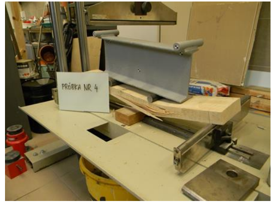
Fotografia 3.3.4 Próbka numer 4 na stanowisku pomiarowym przed i po zniszczeniu
