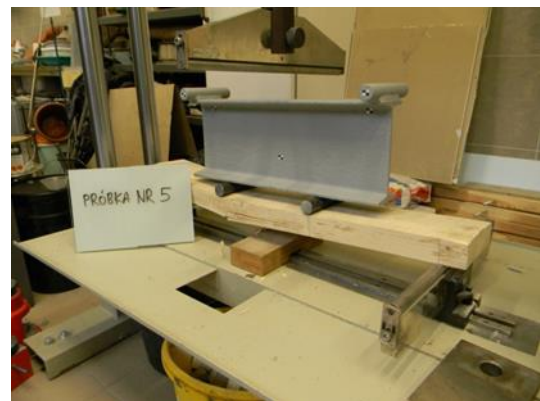
Fotografia 3.3.5 Próbka numer 5 na stanowisku pomiarowym przed i po zniszczeniu
