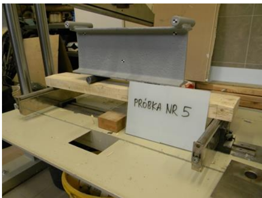
Fotografia 3.3.5 Próbka numer 5 na stanowisku pomiarowym przed i po zniszczeniu
