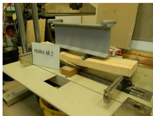
Fotografia 3.3.2 Próbka numer 2 na stanowisku pomiarowym przed i po zniszczeniu
