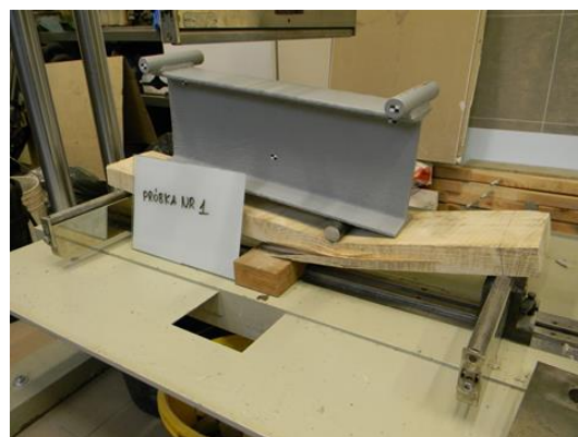
Fotografia 3.3.1 Próbka numer 1 na stanowisku pomiarowym przed i po zniszczeniu
