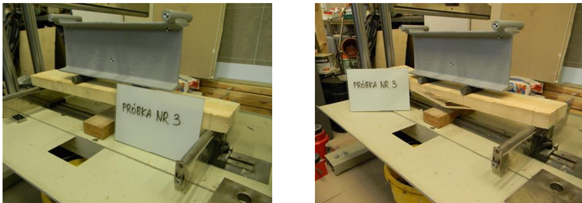
Fotografia 3.3.3 Próbka numer 3 na stanowisku pomiarowym przed i po zniszczeniu
