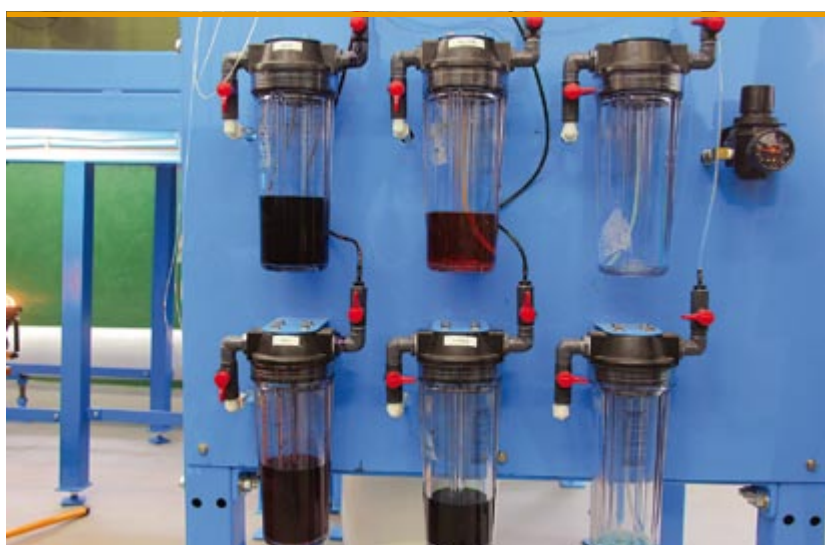
Barwniki służące do wizualizacji strug optywających model samolotu
