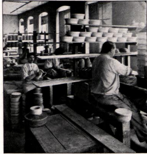
Abbildung 14. Porzellanfabrikation. Formung auf der Drehscheibe.
