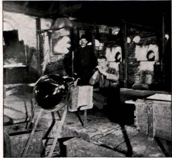
Abbildung 11. Glasindustrie. Aufblasen einer großen Hohlkugel, welche durch nachfolgendes Schwenken zu einer „Walze“ gestreckt werden soll, wie sie für die Fabrikation des Tafelglases erforderlich ist.
