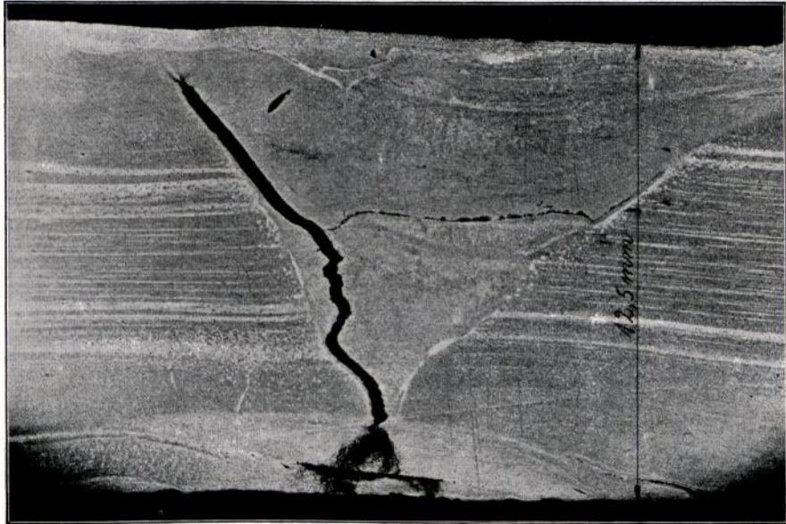
Abbildung 127. Schnitt eines autogen geschweißten Stückes. (Nach Bach.) (Zeitschrift des Vereins deutscher Ingenieure, Berlin.)
