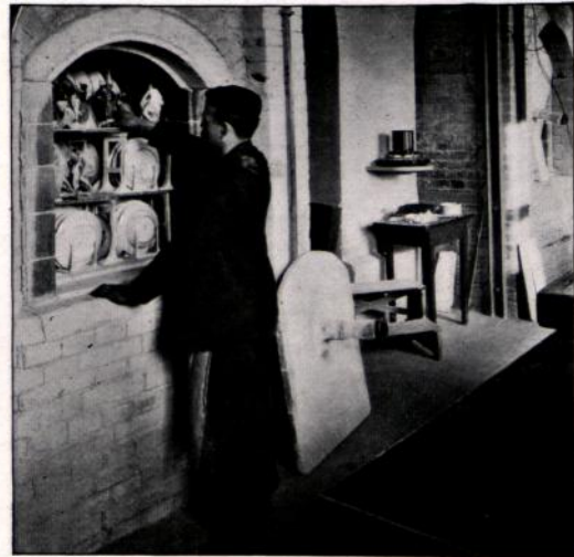
Abbildung 17. Porzellanfabrikation. Dekoration der fertiggebrannten Ware durch Bemalen und Einbrennen der Farben in der Muffel. Aus dem Verlag der Neuen Photographischen Gesellschaft, Steglitz-Berlin: „Das photographische Anschauungsmittel!“.
