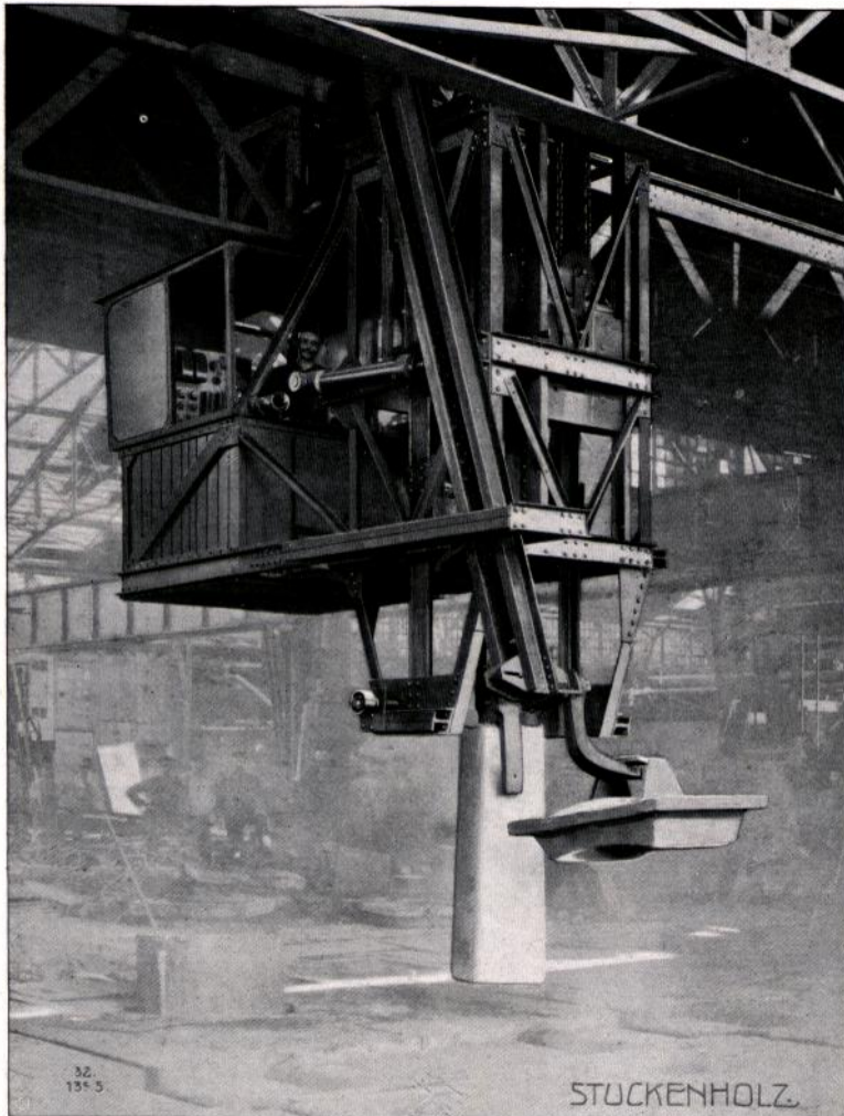
Abbildung 53. Ansicht eines Tiefofenkrans mit Deckelabhebevorrichtung. Gebaut von der Deutschen Maschinenfabrik A.-G. Duisburg.
