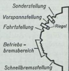
Bild 282. Stellungen des Führerbremshebels des selbsttätigen Führerbremsventils
