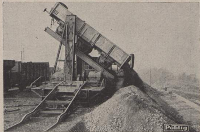
Abb. 4. Fahr- und drehbarer Wagenkipper niedrigster Bauhöhe.
