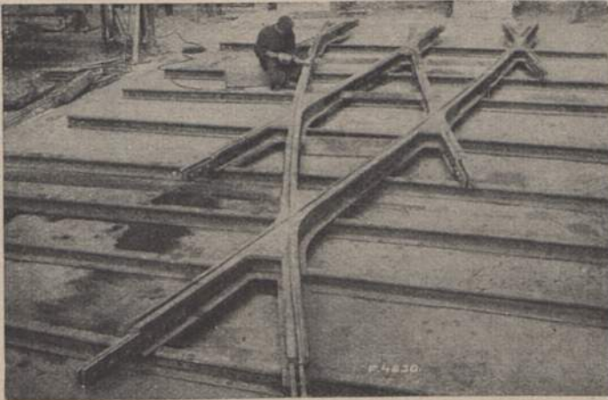
Abb. 6. Kurvenkreuzung, bei der die Anschlußenden fast die Abmessungen der anschließenden Rillenschienen haben.
