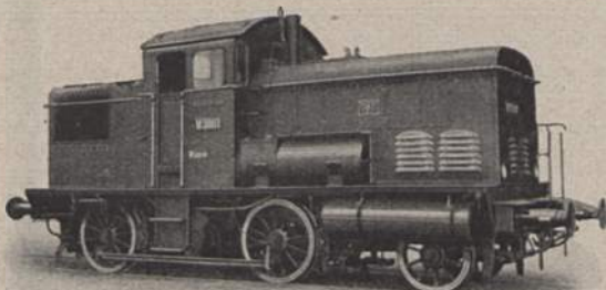
Diesel-Motor-Lokomotive von 250 PS
