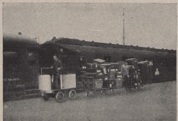
Abb. 6. Akkumulator-Karrenschlepper der Reichsbahn, ausgerüstet mit 40 Elementen der Gattung II J 100.
