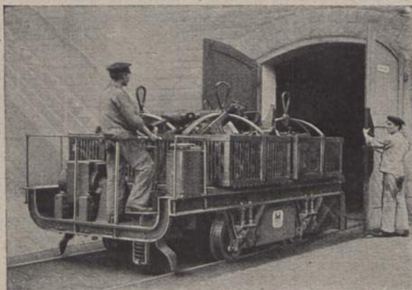
Abb. 5. Akkumulator-Werkstattwagen der Reichsbahn, ausgerüstet mit 80 Elementen der Gattung I J 100.
