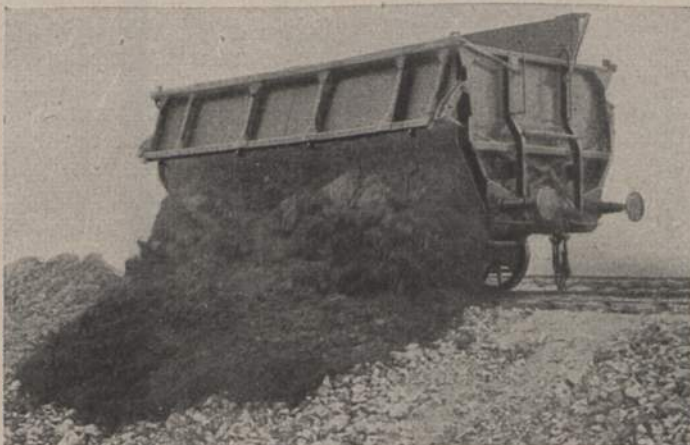
Abb. 26 und 27. Flachboden-Selbstentlader für beiderseitige Entleerung während der Entladung.
