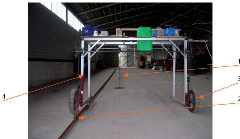
Fot. 1. Widok ogólny stanowiska: 1 – sztuczna roślina, 2 – rolka prowadząca, 3 – koło bieżące, 4 – nośnik rozpylaczy
