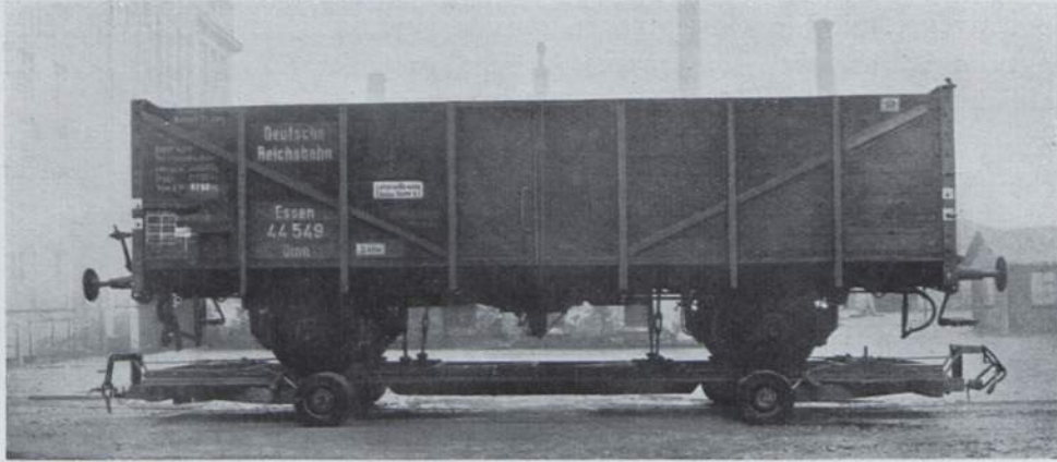
Abb. 53. Versuch von Joh. Pondorf, Gößnitz (Thür.), mit einem 4rädigen Anhänger (1927/28).
