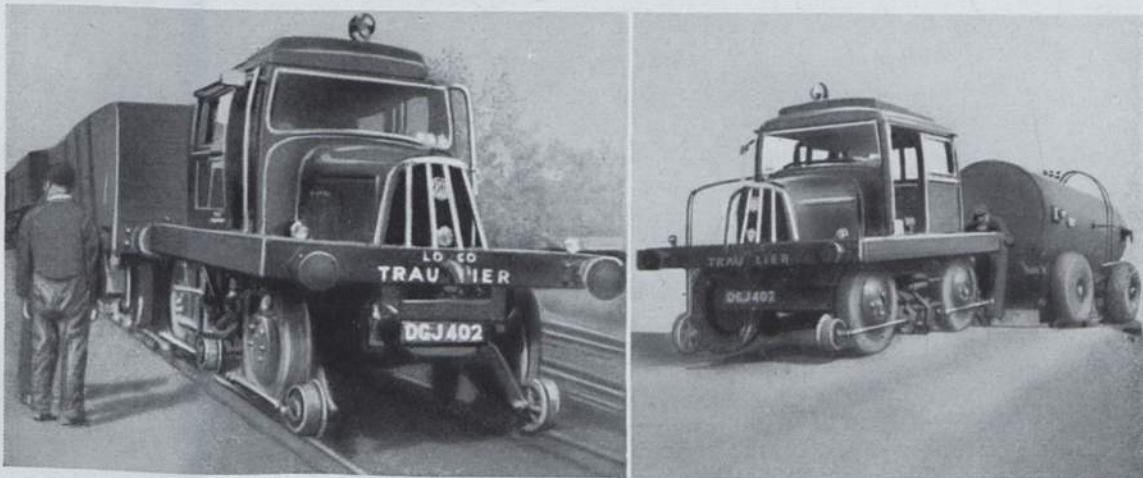
Abb. 12a u. b. Eine engl. Straßenzugmaschine mit Spurrollen für den Schleppdienst auf der Schiene und der Straße. (Foto aus Modern Transport vom 17. 10. 1936.)
