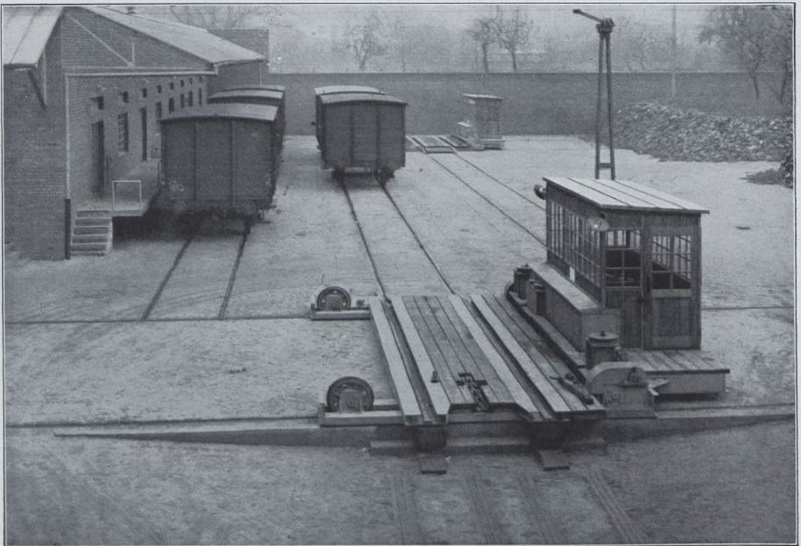
Abb. 257. Größere Absetzanlage für Güterwagen mit Schiebebühnen im Werkhof der Schokoladenfabrik Firma Kaiser, Viersen. Ansicht zur Anlage nach Abb. 255. (Foto Reichsbahn.)
