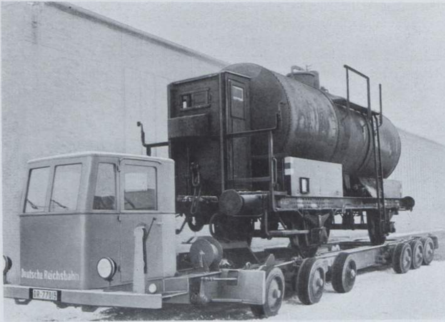
Abb. 191. Einteiliges Straßenfahrzeug mit Eigenantrieb nach dem Ueberladen eines Kesselwagens vorder Ueberladerampe. (Foto GWF.)
