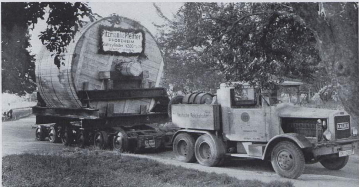
Abb. 356. Beförderung eines 45 t schweren, in einem Tragrahmen längsgelagerten Papierglättzylinders auf kurzgekuppeltem Schwerlastfahrzeug. (Foto Reichsbahn.)
