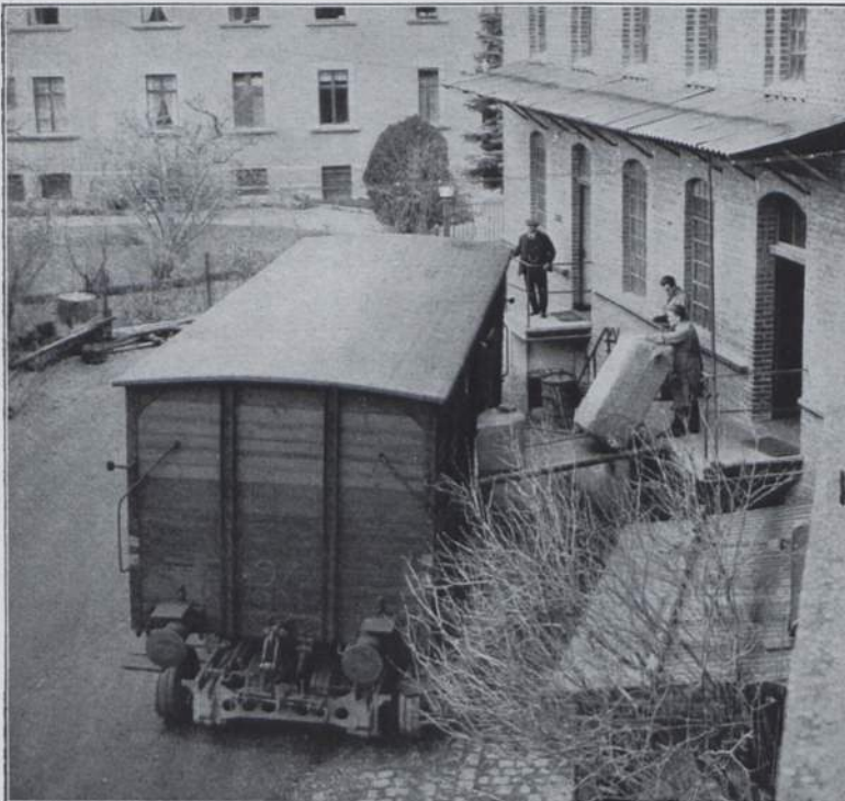
Abb. 246. Einladen von Wolldeckenballen in den auf dem Straßenfahrzeug stehenden G-Wagen auf dem Werkhof der Ascherslebener Wolldeckenfabrik. (Foto Reichsbahn.)
