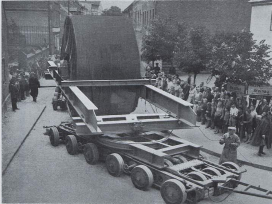
Abb. 361. Glättzylinder auf zwei Straßenfahr- zeugen zwischen Verbindungs- trägern hängend, in starker Krümmung. (Foto Reichsbahn.)
