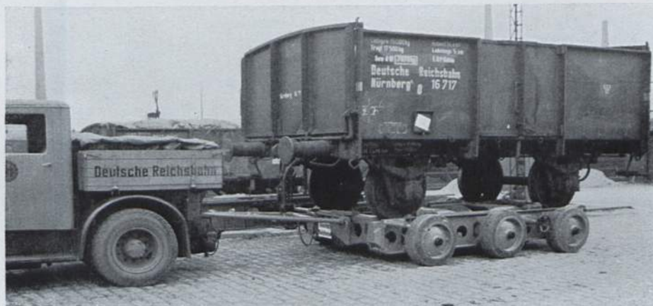
Abb. 112b. Kurzer O-Wagen auf einem Fahr- gestell des 24 rädri- gen Straßenfahrzeugs. (Foto Reichsbahn.)
