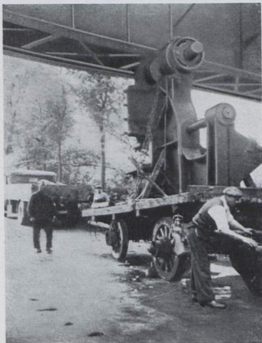
Abb. 305. Primitivfahrzeug mit 21,2 t schwerem Kurbelhammer, unter Eisenbahnbrücke eingeklemmt. (Foto Reichsbahn.)
