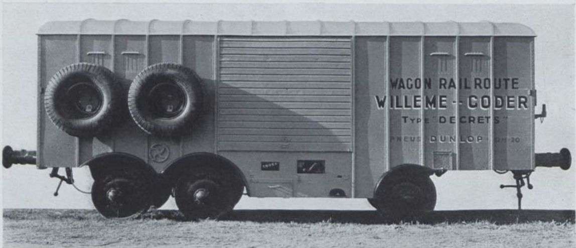
Abb. 26. Dreiachsiges Schienen-Straßen-Fahrzeug nach Willème-Coder. (Werkfoto.)
