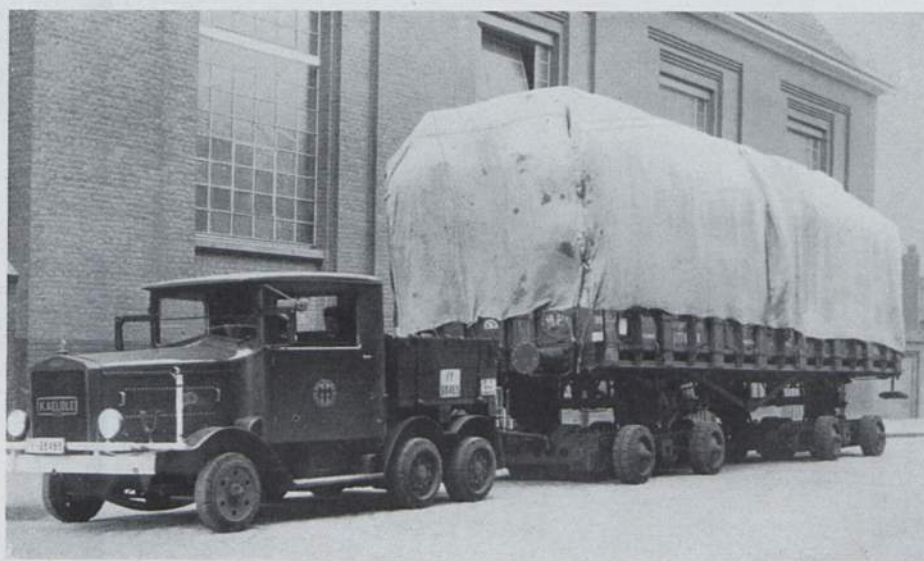
Abb. 280 Beförderung hoch- beladener Rungen- wagen. (Foto Reichsbahn.)
