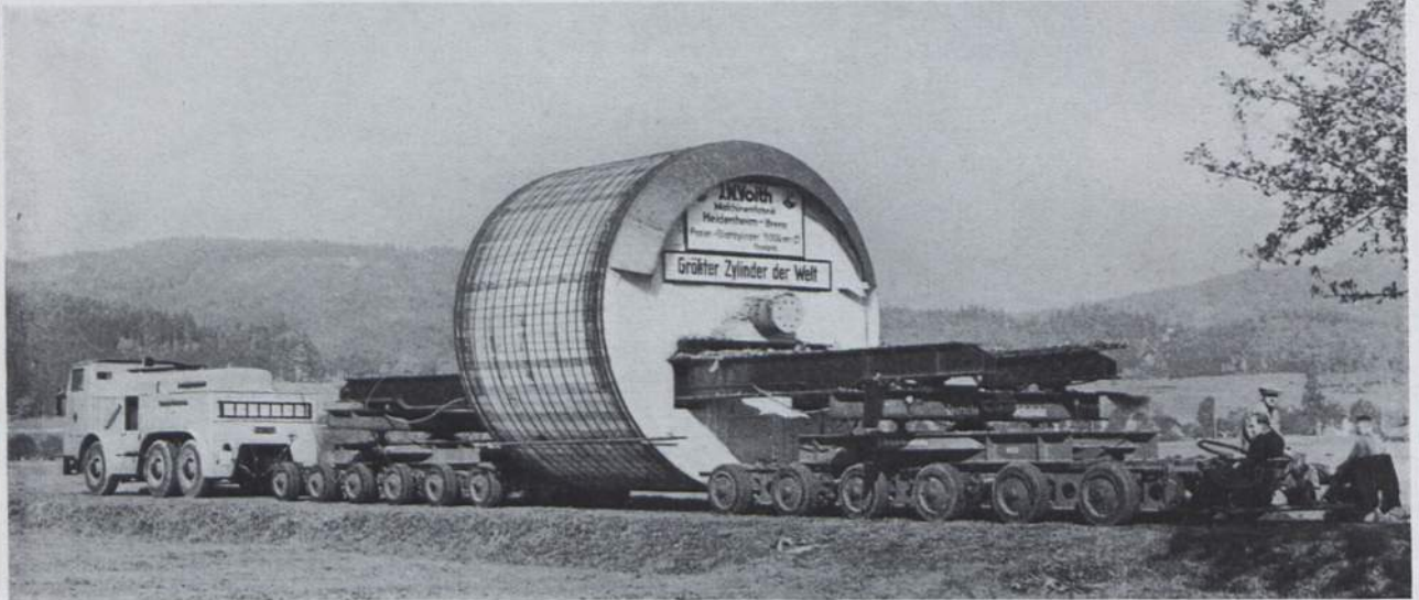
Abb. 366. Schwerlastzug mit 180-PS-Schlepper der Reichsbahn befördert 65 t schweren Papierglätzylinder von 5 m Durchmesser mit durchgesteckten Verbindungsträgern auf zwei Straßenfahrzeugen mit 48 Rädern. (Foto Reichsbahn.)
