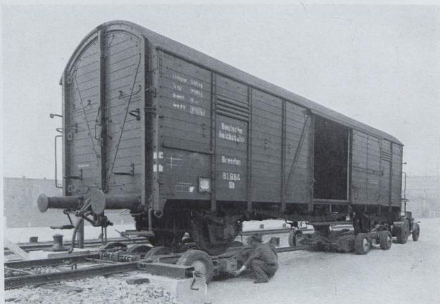
Abb. 114. Absenken des aufgefahrenen Glt-Wagens um 21 cm durch Lösen des Pumpenventils. (Foto Reichsbahn.)
