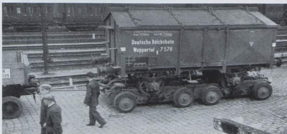
Abb. 112a. Klappdeckelwagen mit 3 m Achsstand auf kurzgekuppel- tem, 16 rädri- gem Straßenfahrzeug. (Foto Reichsbahn.)
