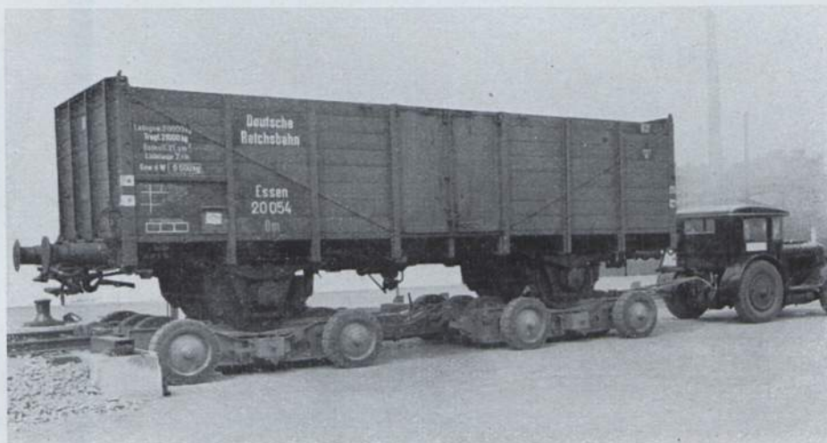
Abb. 112. 20-t-Wagen ganz aufgefahren, in Hochlage, ab- fahrbereit. (Foto Reichsbahn.)
