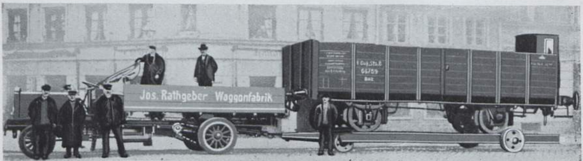
Abb. 42. Beförderung von Eisenbahnwagen auf Anhängern hinter Lastkraftwagen (Deutsche Straßen- und Kleinbahnzeitung 1911).
