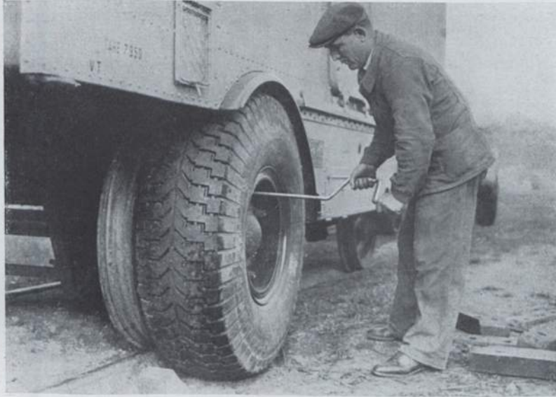
Abb. 23. Anbringen der Straßenräder an den Schienen-Straßen-Fahrzeugen nach Willème-Coder. (Werkfoto.)
