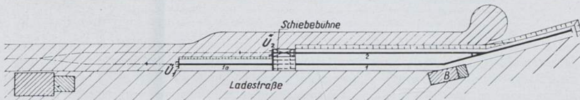
Abb. 240. Grundriß der Ueberladeanlage mit 2 Rampen und Schiebebühne.
