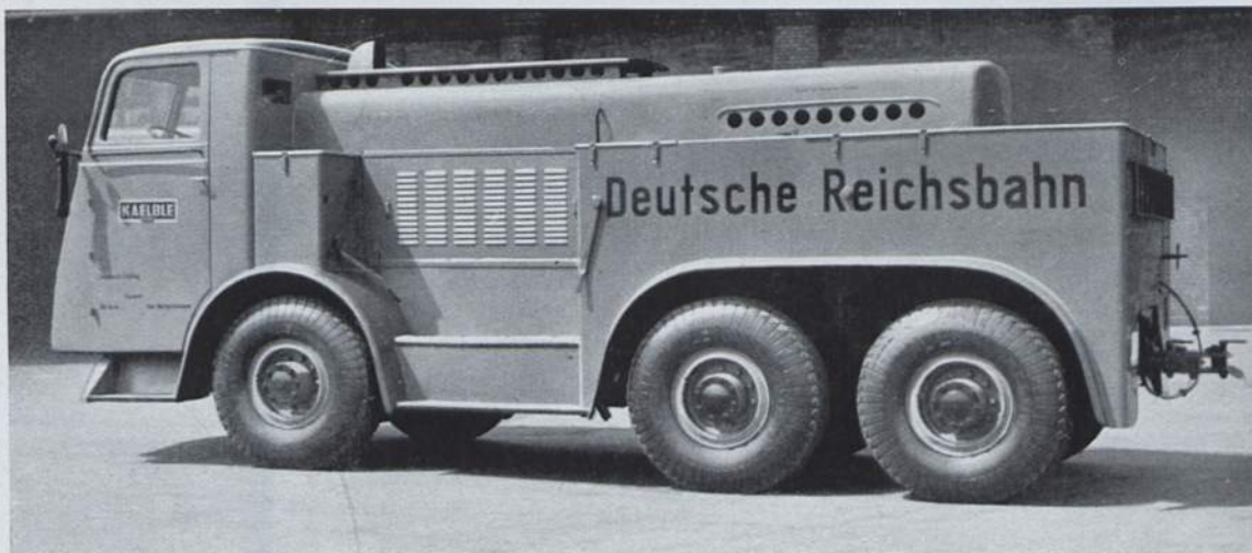
Abb. 204. 180 PS-Schlepper der Deutschen Reichsbahn mit 6 Treibrädern (gebaut 1937 von Fa. Kaelble, Backnang, Württbg.) (Foto Reichsbahn.)
