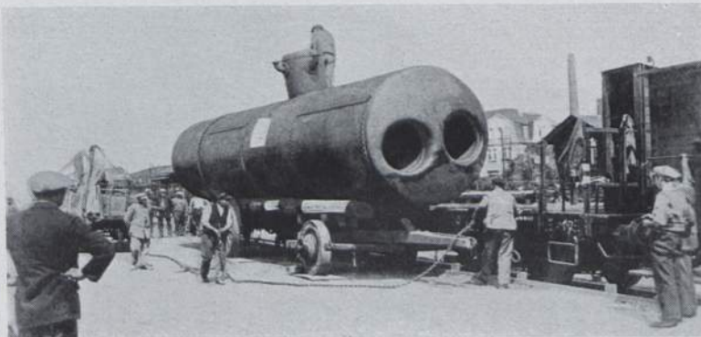
Abb. 301. Kesselwagen mit 29,5 t Last auf Bleche gestellt. (Foto Reichsbahn.)
