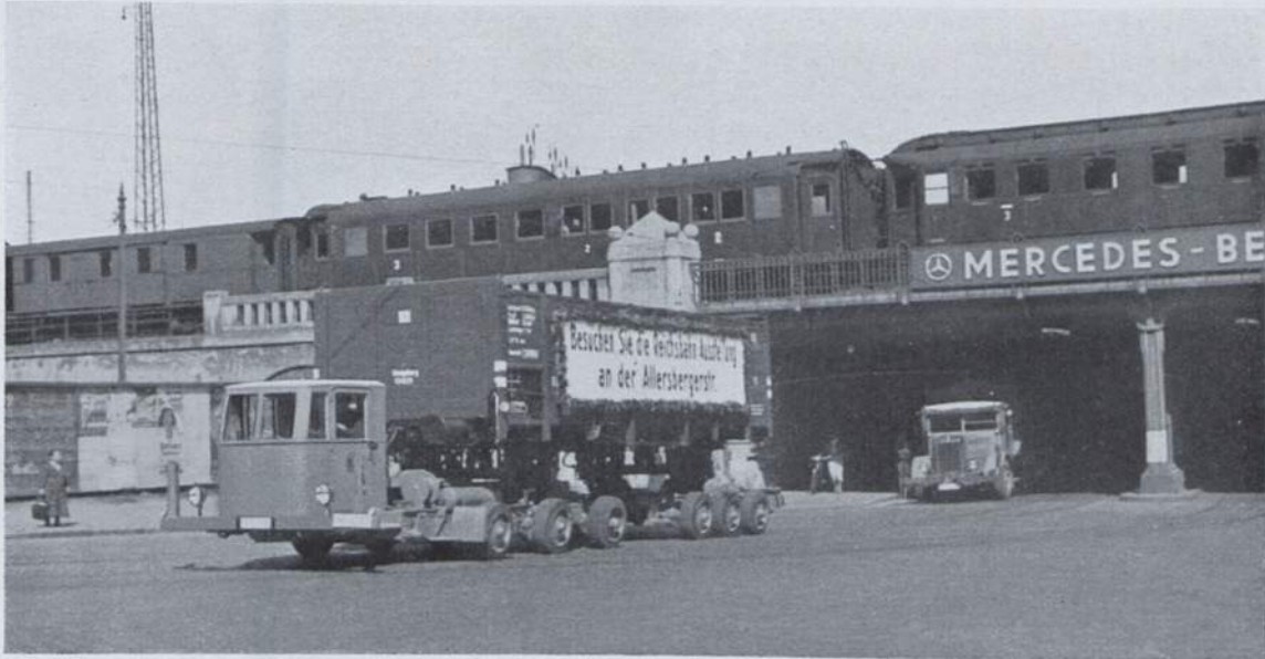
Abb. 185. Ausziehbares Straßenfahrzeug mit Eigenantrieb, in Nürnberg fahrend. (Foto Reichsbahn.)
