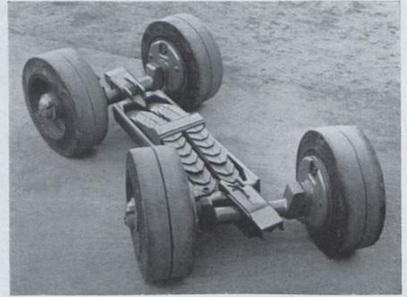
Abb. 149. Achsfahrgestell des 16rädigen Straßenfahrzeugs mit durchgehender Fahrbahn. (Foto GWF.)
