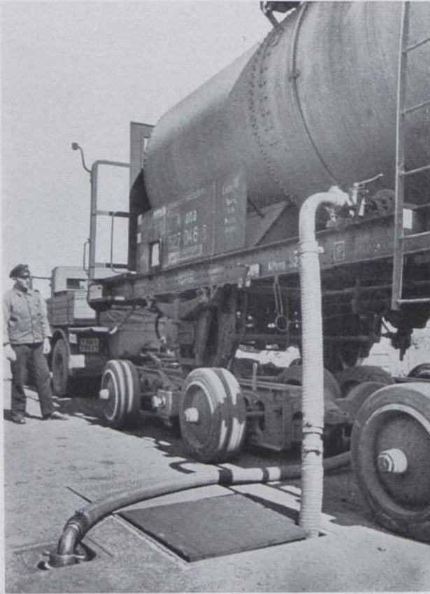
Abb. 293. Entladen eines Kesselwagens mit flüssigem Brennstoff durch zwei Schläuche in Elmshorn. (Foto Reichsbahn.)
