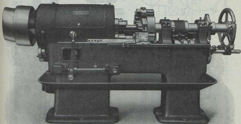
Abb. 337. Vierspindel-Halbautomat. Gildemeister & Co., A. G., Bielefeld.
