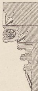
Rys: 297. Nadwieszenie belek piętrowych z dodaniem wsporników. Kołomir lęchicki na belce w przekroju. (Halberstadt w Prusiech).
