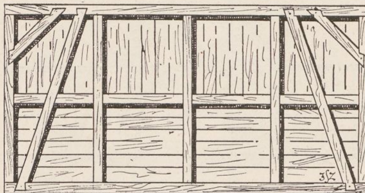
Rys. 100. Stodoła o czterech przęsłach z dwóch czwartaków. Środkiem słup przecina się w krzyż z rozporą. W przęsłach skrajnych zastrzały strome i miecze równoramienne.
