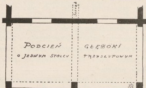
Rys: 26. Podcień głęboki „dwudzielny“ o trzech słupach.
