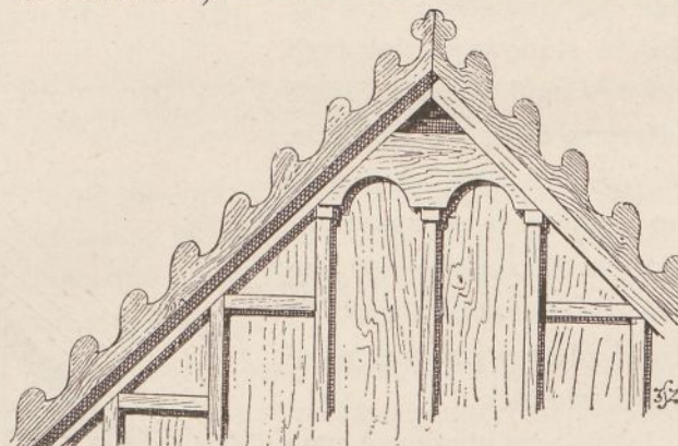
Rys: 233. Szczytnica o dwunałęczu pod trójkątem „kalenicy”. Z domu starego we Wiśle, koło kościoła.
