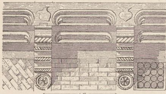
Rys: 297. Nadwieszenie belek piętrowych z dodaniem wsporników. Kołomir lęchicki na belce w przekroju. (Halberstadt w Prusiech).
