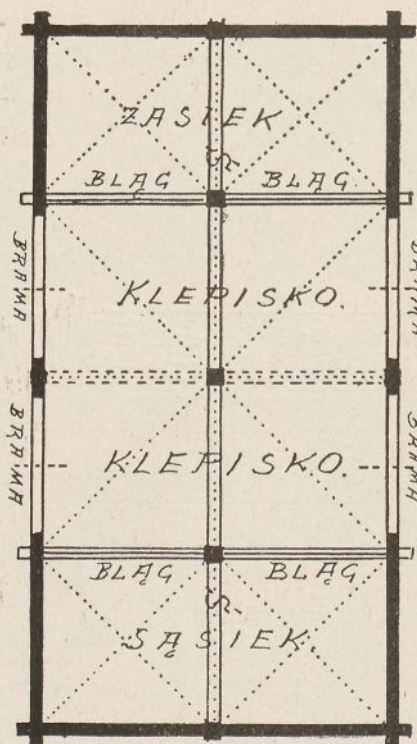
Rys: 13. Rzut poziomy stodoły, założonej na dwóch czwartakach, czterodzielnych.
