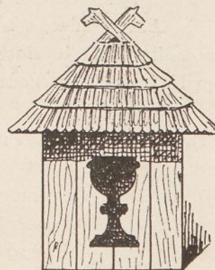
Rys: 194. Okienko strychowe jako dymnik ze Żubrzyca Wyżniej. (Kielich znakiem naczyńia duchownego).
