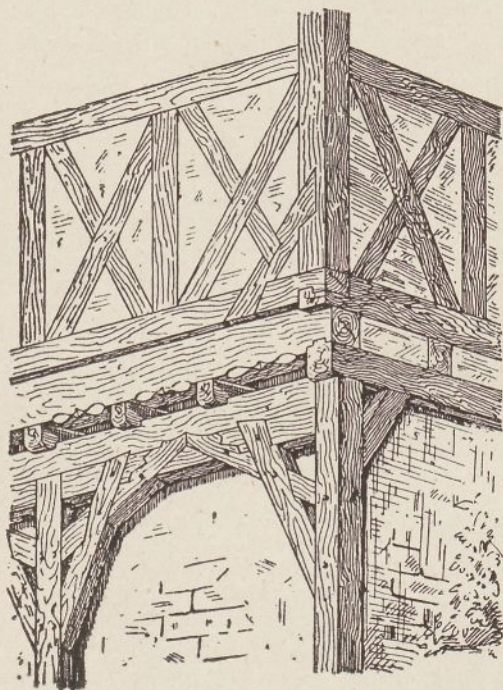
Rys: 138. Mieczowania „piastowskie” ze Śląska. (Das Bauernhaus in Deutschland).
