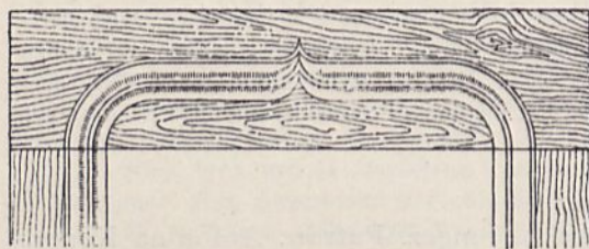
Fig. 83. Modlnica. Nadproże odrzwi wejścia z prezbiterium do zakrystyi.
