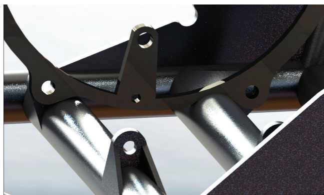
Rys. 3. Przewężenie tylnego mocowania
