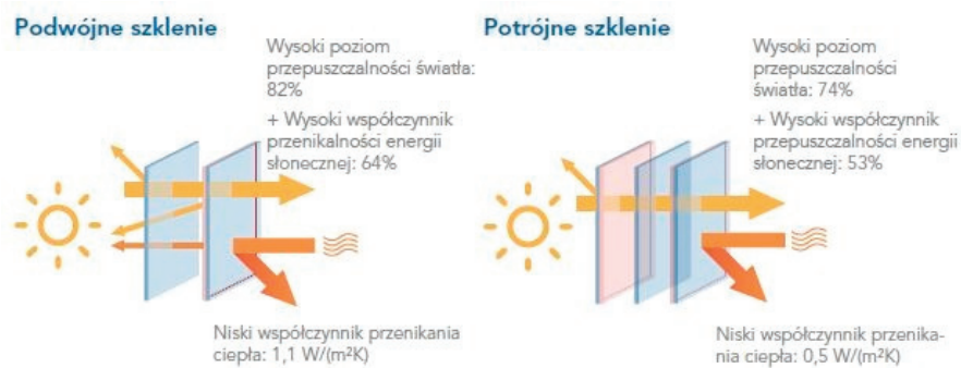
Rys. 6. Porównanie przeszkleń w budynku tradycyjnym i pasywnym [5]
