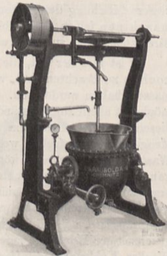
Abb. 1. Appreturkochkessel mit Rührwerk und Doppelmantel. (C. G. Haubold A.-G., Chemnitz.)
