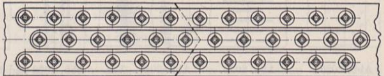
Abb. 2032. Schloß für Textilriemen nach Kammerer. (Im Längsschnitt sind die mittleren Schrauben weggelassen.)
