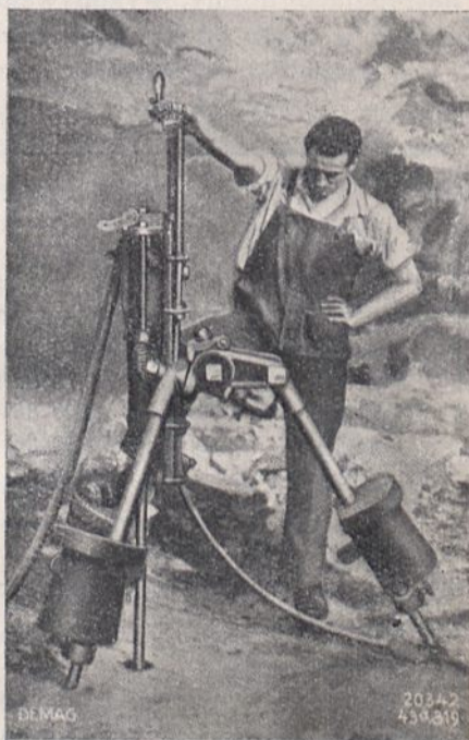
Rys. 27a: Świder mechaniczny „Demag” na trójnogu o skoku tłoka 75 — 60 mm i wadze 42 — 81 kg, porusz. spręż. powietrzem.
