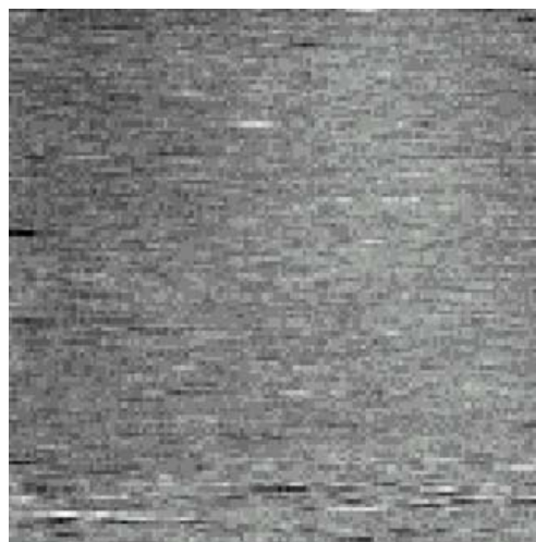
Rys. 12.26. Obraz sił elektrostatycznych obserwowanych na powierzchni metalizacji osadzonej na powierzchni piezorezystywnego czujnika siły (pole skanowania 35 \times 35 \mu\text{m} , 256 \times 256 linii) – potencjał przyłożony do metalizacji 2,5 V
