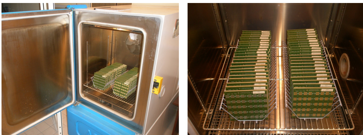
Rysunek 4.9: Testowe płytki obwodów drukowanych przed procesem starzenia w komorze klimatycznej
