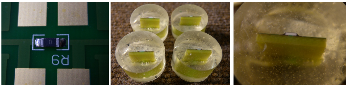
Rysunek 5.1: Zwora SMD 1206 przylutowana do powierzchni płytki testowej, badane struktury zatopione w żywicy epoksydowej i zglądy po procesie szlifowania
