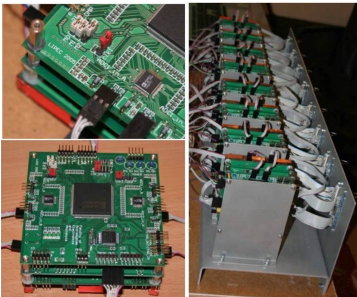
Rysunek 8.21: Konstrukcja pojedynczego modułu oraz kompletnego systemu
